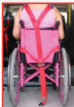
Cintura a doppia bretella per la persona con aggancio su guida. Versione con un solo punto di aggancio posteriore o con due, da scegliere in base al posizionamento delle guide rispetto alla carrozzina
